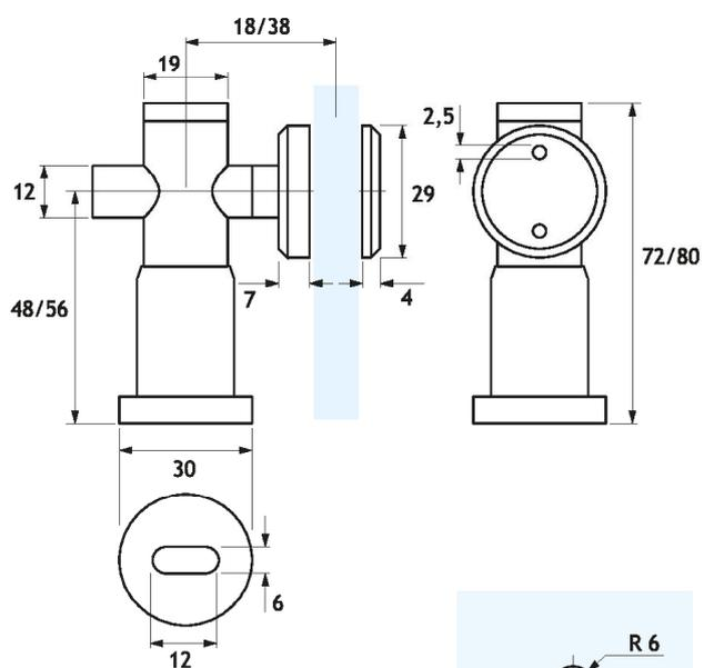
Connettore angolare a 90° vetro/muro con fissaggio a punto
